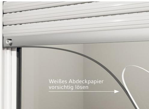
Messen Sie zunächst die Panzerendleiste (Unterkante des Rollladens) ab und schneiden Sie soni SOFT-CLOSE mit einem Cutter-Messer auf die richtige Länge zu.
