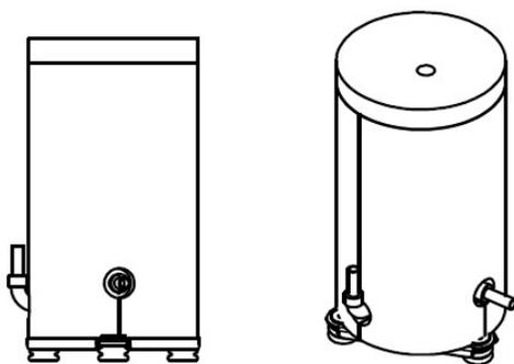
Envelopper le compresseur avec la housse - face noire vers l'extérieur. Poser le capot puis assembler avec la bande adhésive soni VLC-01.
